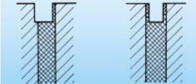
Versetzt ausgesägt (falsch)
